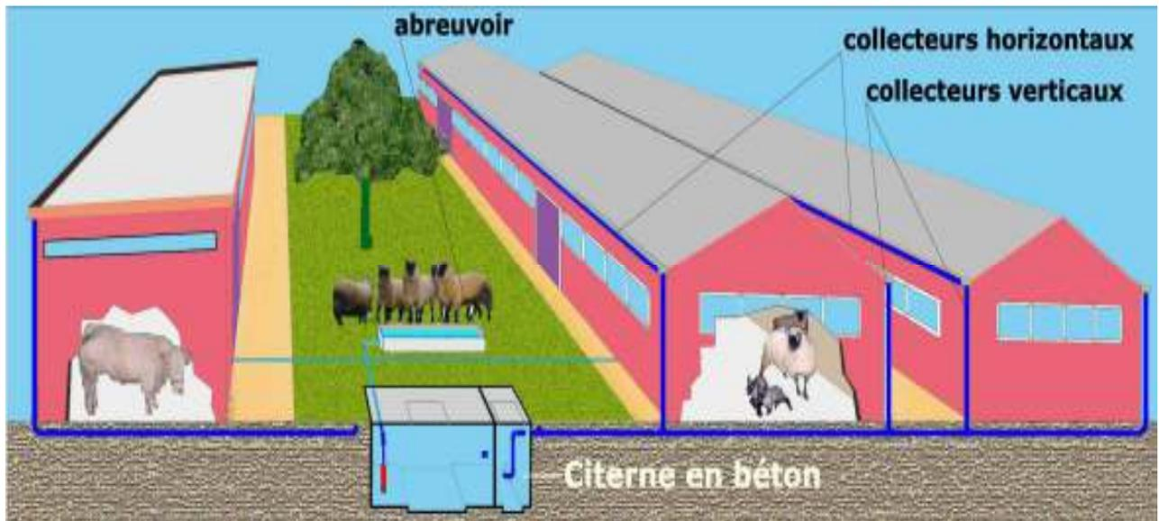
**Synoptique n°12 : Système de récupération d'eau de pluie /Bâtiment à usage agricole**
